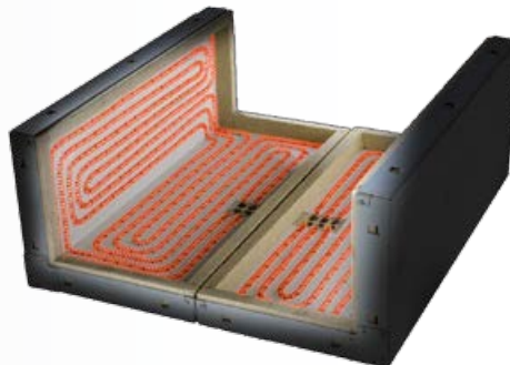
Spezielle elektrische Heizkörper aus Wolfram
